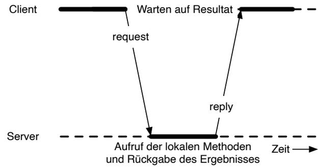
Die Verbindung zwischen Client und Server bei einem asynchronen RPC. Der Client wird nicht blockiert.
